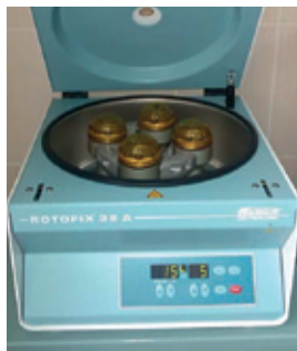
Рис. № 1. Центрифуга для получения PRP.
