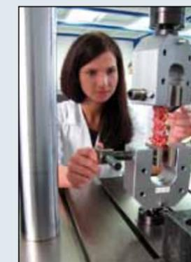
Фото 7. Закрепление образца в захваты
